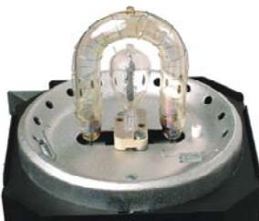
Le tube flash, qui est monté vers l'avant, et la lampe pilote sont enfermés dans un verre de protection, ce qui permet au photographe d'avoir une meilleure vue sur la relation entre la lumière du flash et de la lampe pilote. Tout se passe comme si les deux lumières sont situées au même endroit. Ceci est important lors de l'utilisation d'accessoires.
