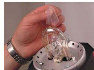
**Etape 4.** Placer la lampe halogène dans la douille en porcelaine et écarter la feuille de protection. Faites attention de ne pas toucher le tube flash.
