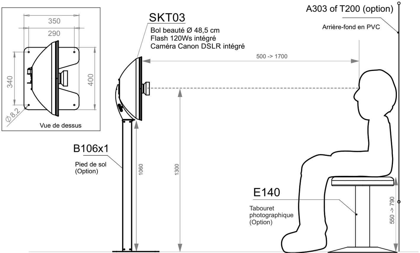
Exemple de disposition : Système Photo d'identité avec statif robuste sur plateau de sol
