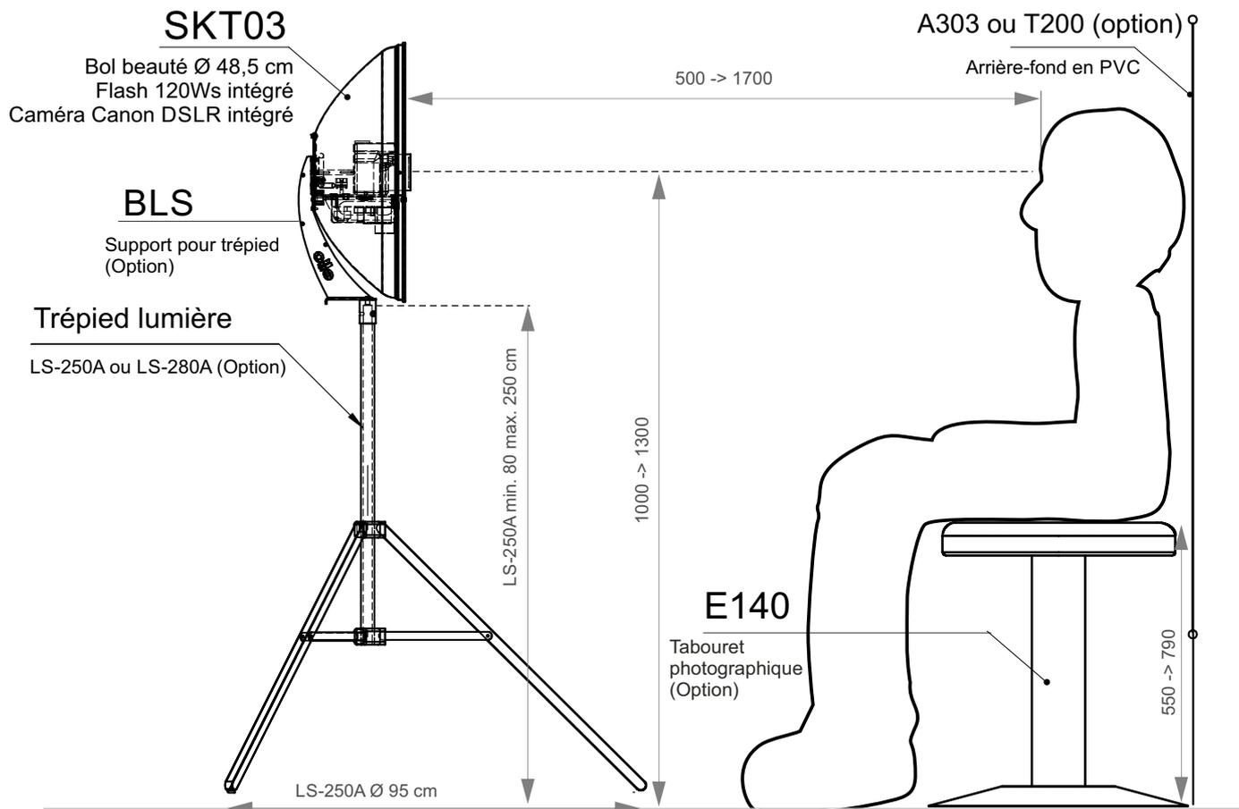
Exemple de disposition : Système Photo d'identité pour placement sur trépied lumière optionnel
