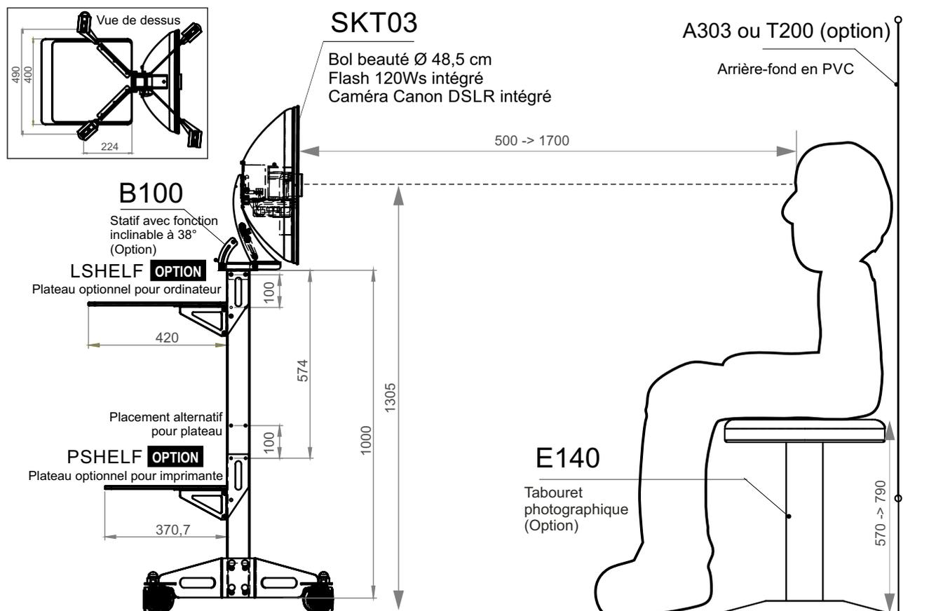
Exemple de disposition : Système Photo d'identité avec statif robuste sur roulettes et fonction inclinable (à max. 38°)
