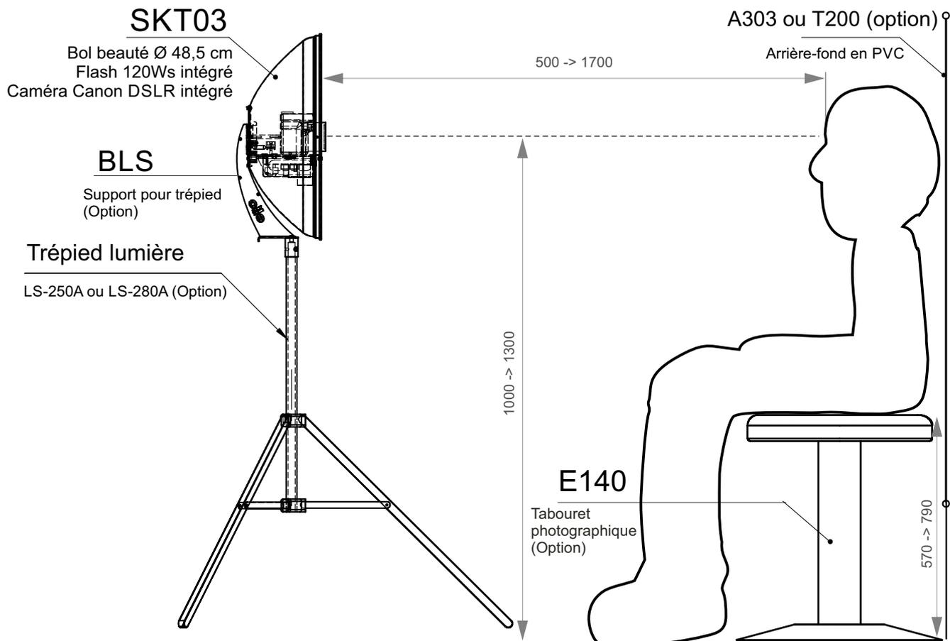
Exemple de disposition : Système Photo d'identité pour placement sur trépied lumière optionnel
