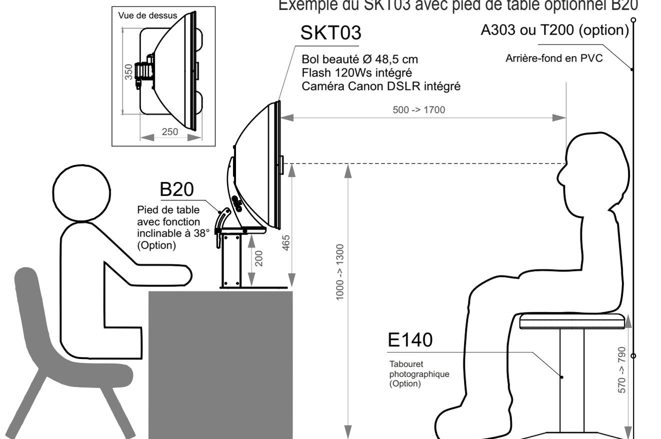
Exemple de disposition : Système Photo d'identité pour placement sur une table ou un bureau, pied avec fonction inclinable (à max. 38°)
